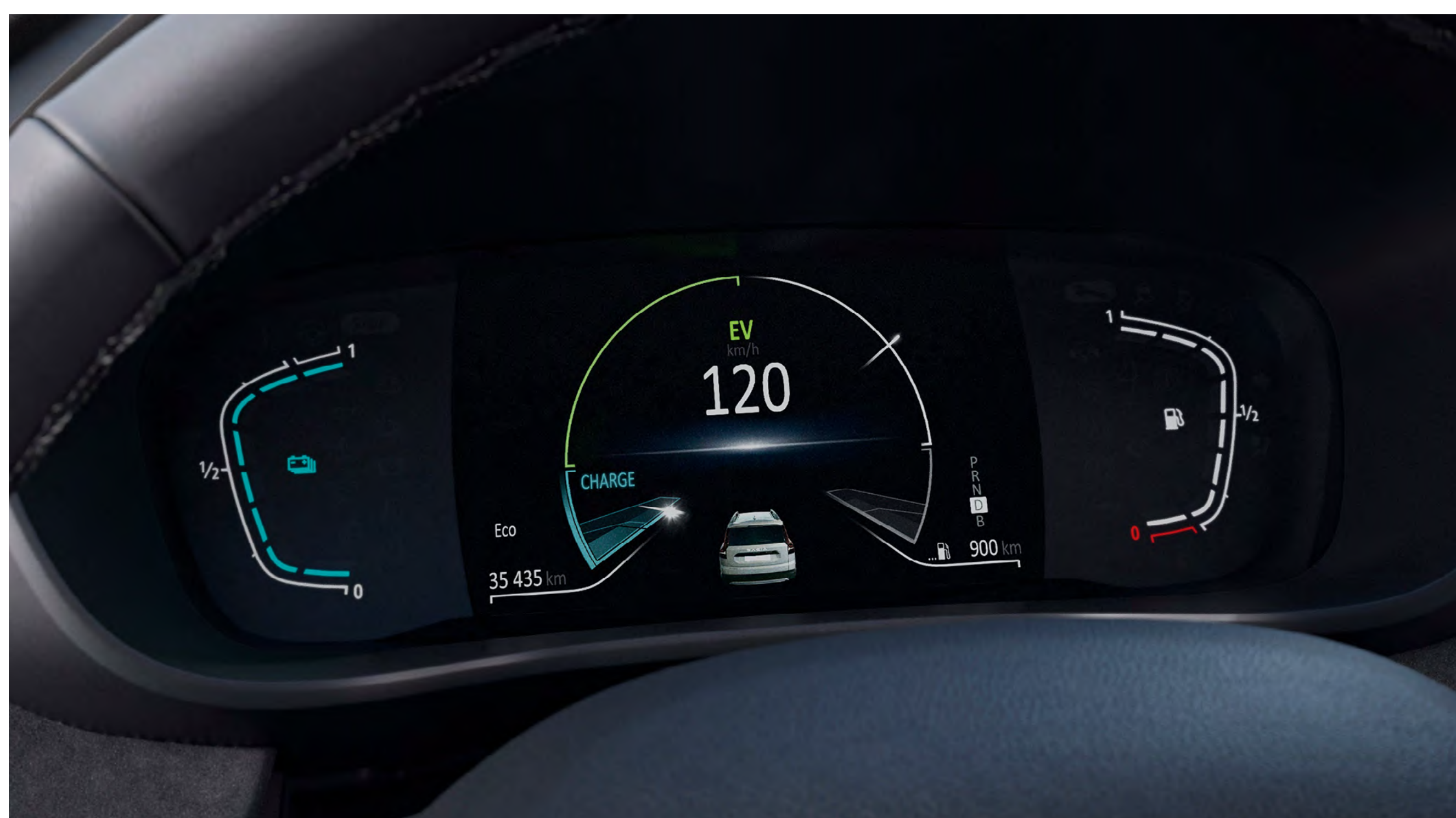
Panou de instrumente color de 7" cu informații despre modul de condus
